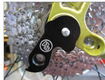
図4 - ストレートドロップアウトエンドでのセットスクリュー取り付け位置
