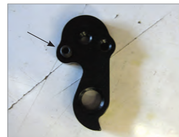
図2 - ストレートドロップアウトエンドでのセットスクリュー取り付け位置
