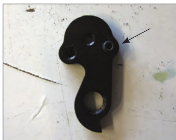
図1 - 水平ドロップアウトでのセットスクリュー取り付け位置
