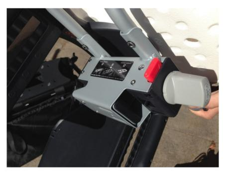
シートを装着する前に赤いタブを押さえ、灰色のノブが止まる所まで反時計回りにまわします。これによりくさびが完全に収納され、デッキロでシートが引き止められることもなくなります。
