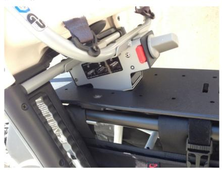
シートを前に傾け、まずくさびの前側を先に挿入し、その後シートを後ろに戻します。
